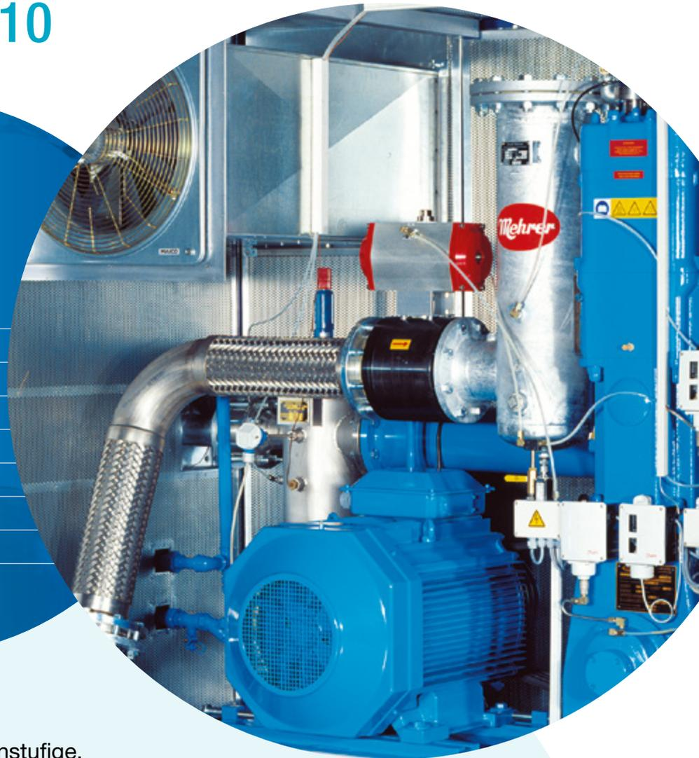
Der TEW 90 und TEW 110 sind einstufige, wassergekühlte Kompressoren. Produkte dieser Baureihe werden vorwiegend in der Nahrungsmittel- & Getränkeindustrie sowie im Maschinenbau eingesetzt. Sie zeichnen sich durch ihre öl- und silikonfreie Verdichtung aus. Die Reihenmaschinen arbeiten vertikal und ermöglichen somit einen platzsparenden Aufbau. Die Kompressoren können mit Vordruck und frequenz geregelter Drehzahl betrieben werden.
