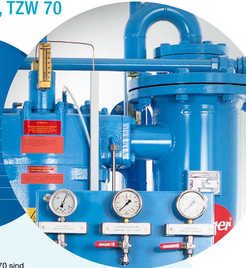
Der TZW 50, TZW 60 sowie TZW 70 sind zweistufige, wassergekühlte Kompressoren. Produkte dieser Baureihe werden vorwiegend in der Nahrungsmittel- & Getränkeindustrie sowie im Maschinenbau eingesetzt. Sie zeichnen sich durch ihre öl- und silikonfreie Verdichtung aus. Die Reihenmaschinen arbeiten vertikal und ermöglichen somit einen platzsparenden Aufbau. Die Kompressoren können mit Vordruck und frequenz geregelter Drehzahl betrieben werden.
