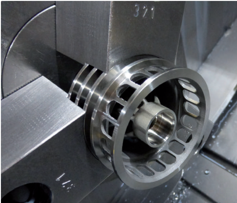
Abb. 4: Additiv gefertigter Kolbenrohling in Bearbeitung der Kolbenringnuten und der Führungsringnut
