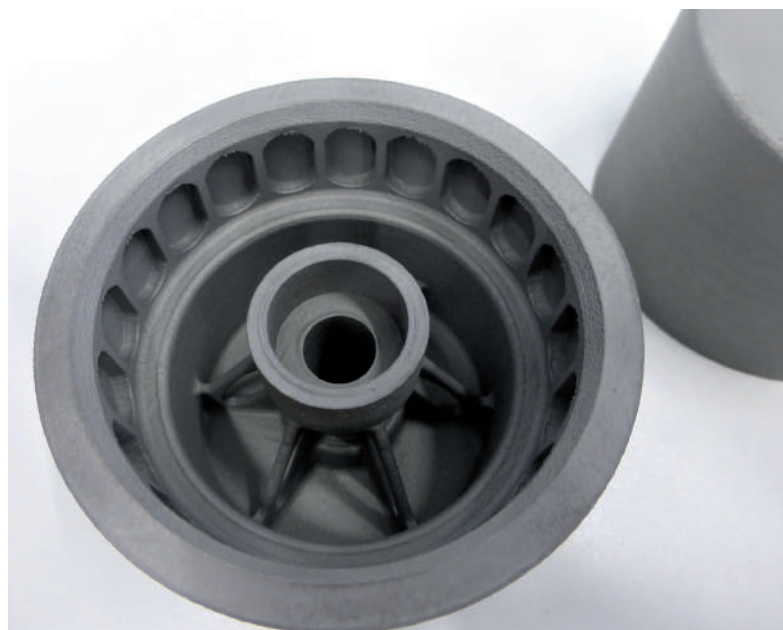
Abb. 3: Additiv gefertigter Pleuelring aus Edelstahl
