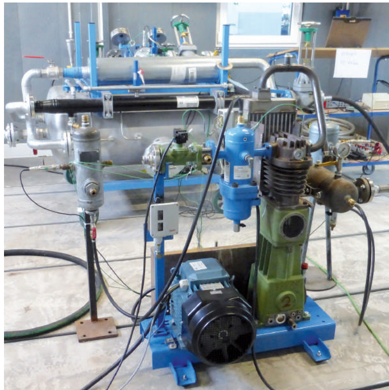
Abb. 6: Testkompressor mit Kolbenprüflingen im Testfeld
