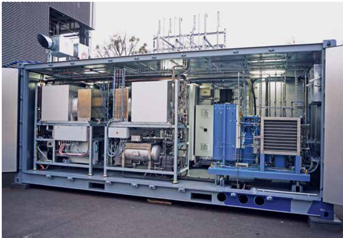
Abb. 2: Die Sunfire GmbH setzt Kompressoren unter anderem für eine weitere Kompressionsstufe des Wasserstoffs bei Brennstoffzellen in Fahrzeugen ein.
