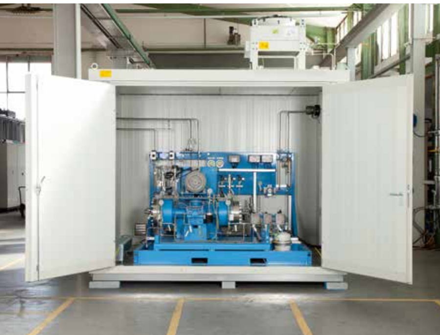
Abb. 4: Schlüsselfertige Container-Lösungen in Ex-Ausführung können vorab an die kundenseitigen Anforderungen angepasst werden.
